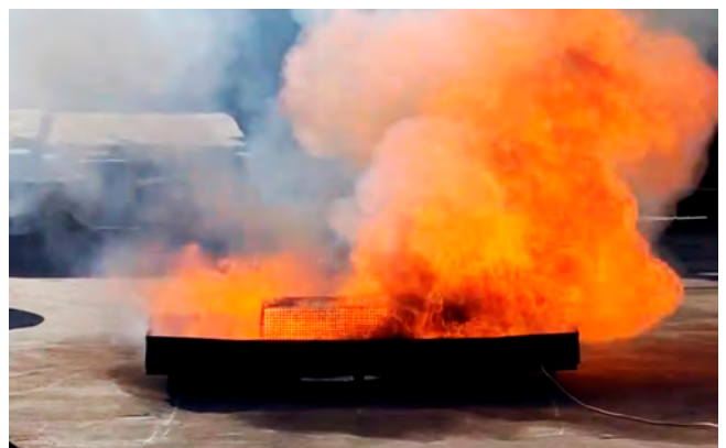
Foto 3: Phase 2 – Der Akku ist im Vollbrand und erzeugt eine enorme Hitzewelle.
