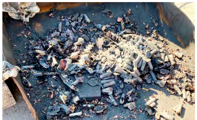
Foto 4: Phase 3 – Die Rückstände nach Abschluss des Brandversuches.
