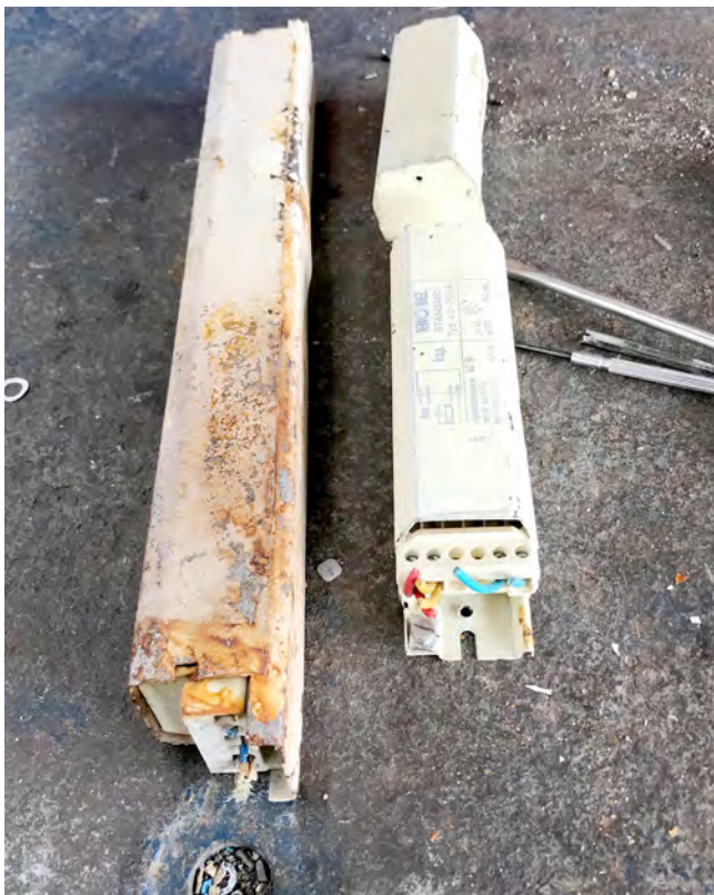
Foto 2: Zwei verdächtige VG, die im Rahmen der Qualitätssicherung in einem Gebinde mit nicht-verdächtigen VG gefunden wurden. Das elektrische Schema auf dem rechten VG deutet mit einem Symbol und mit «Kap» auf den Kondensator (kapazitiver Teil).
