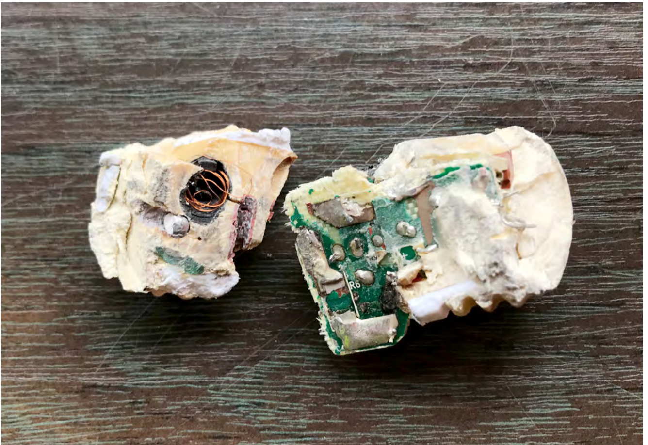
Foto 2: In gewissen LED sind die wertvollen Leiterplatten eingegossen.
