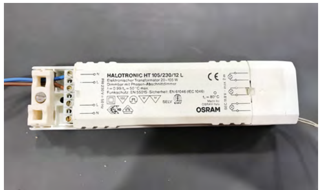
Foto 3: Elektronisches Vorschaltgerät (nicht PCB-verdächtig).
