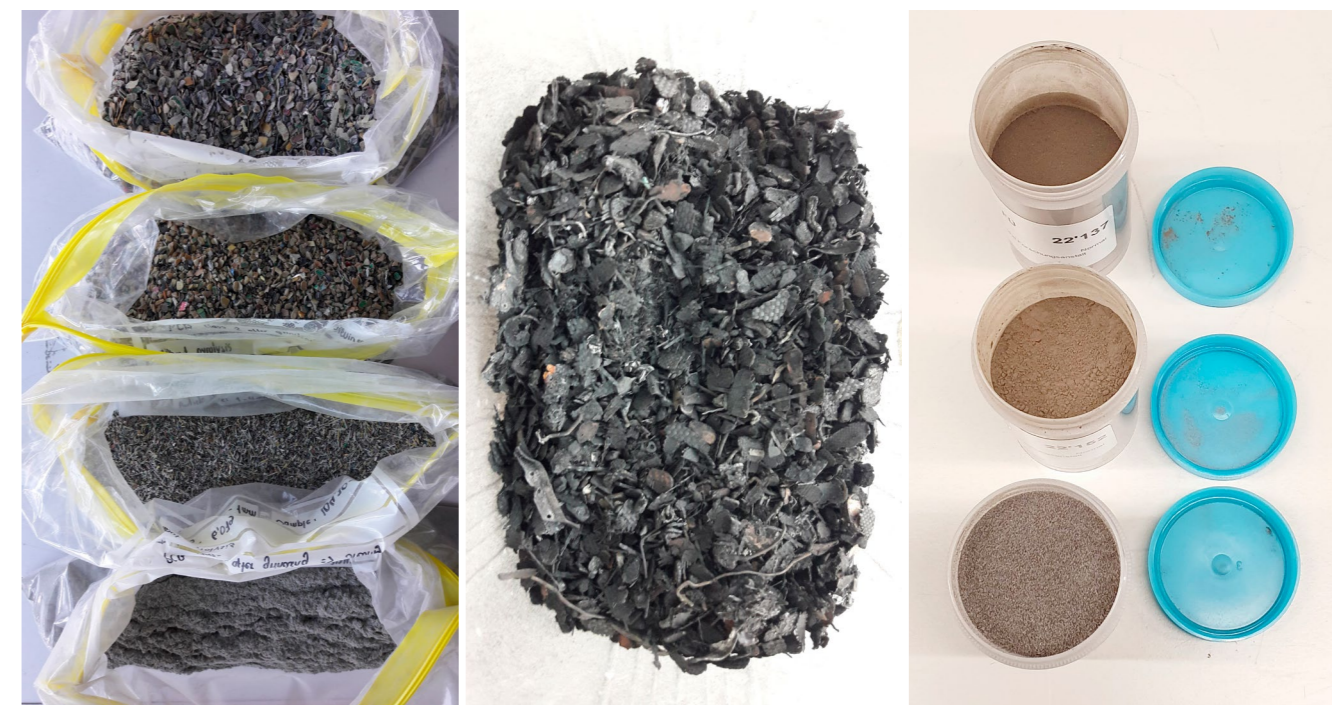
Figure 5: exemples d'échantillons préparés (de gauche à droite): fractions criblées de différentes tailles de grains de circuits imprimés moulus qui servent à l'étude de la répartition des différents matériaux (notamment des métaux précieux) dans les différentes matrices; fraction de circuit imprimé pyrolysée à partir de laquelle tous les composants volatiles ont été enlevés, séparés dans des solutions et étudiés; fractions moulues générées dans un moulin de laboratoire (de bas en haut: fraction de matières plastiques, scories de dépoussiéreur humide, RESH).
