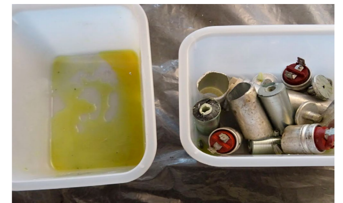
Photo 1: séparation de solides et liquides au bout d'une période d'écoulement de quatre mois.
