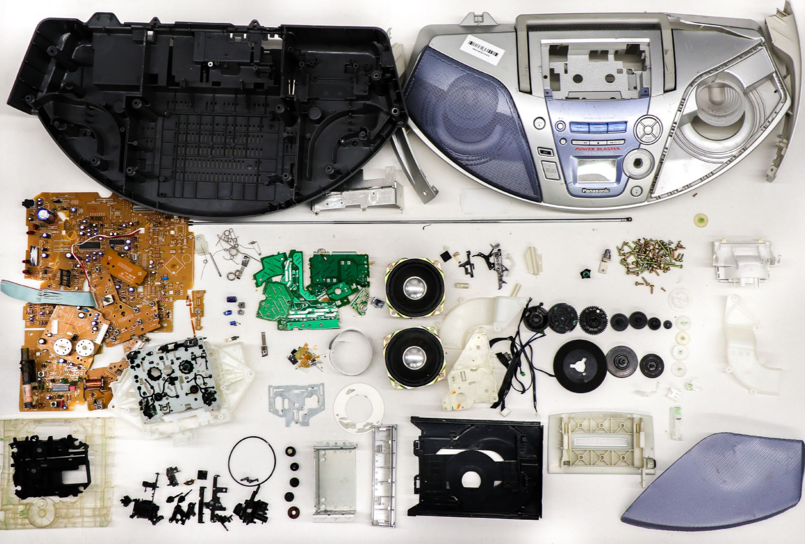
Figure 3: ghettablaster après un démontage fin.
