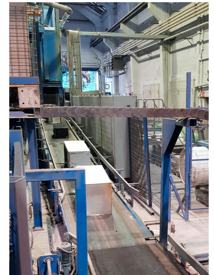
Photo 3: bande de déversement des appareils pour le niveau de traitement 2.
